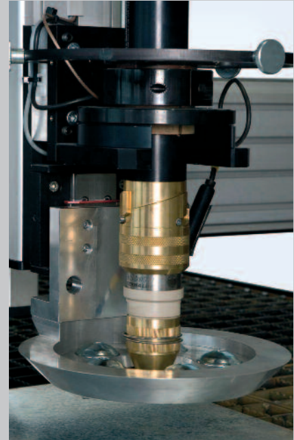
Wechselkopfbrenner mit Magnet-havarie und Niederhalter (Option) Quick-change head torch with magnetic collision protection and plate hold-down device (Option)
