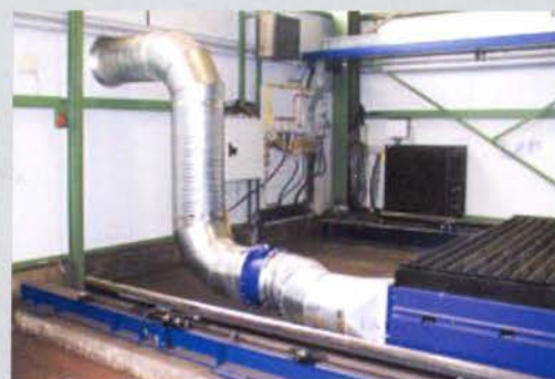
Anschluss der Rohrleitung an den Absaugtisch Connection of the ducting to the fume extraction table
