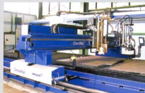
Modulkonstruktion des Tisches mit pneumatischer Steuerung der Tischsektionen Modular table design with pneumatic control of the table sections
